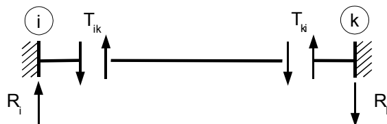
Rys. 1.9. Reakcje podporowe i przywęzłowe siły poprzeczne
