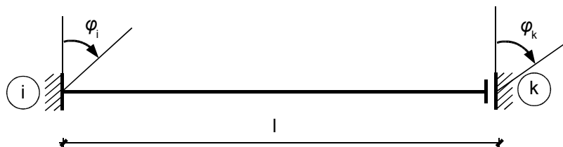
Rys. 1.16. Schemat belki utwierdzonej z przesuwem
