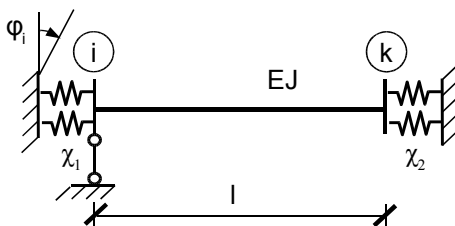
Rys. 16.50. Belka statycznie niewyznaczalna sprężystie podparta
